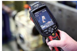
减速箱运行时的热图像检测
