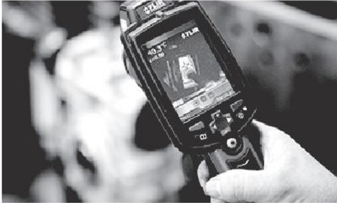
减速箱运行时的热图像检测
