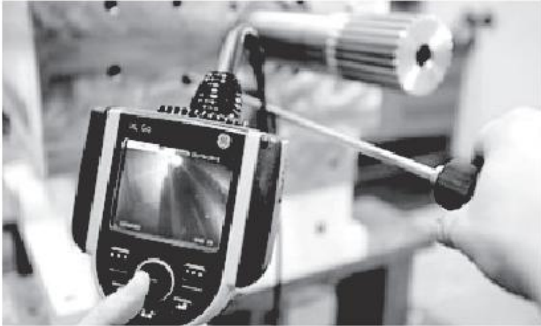
不用拆卸减速箱诊断过程中
