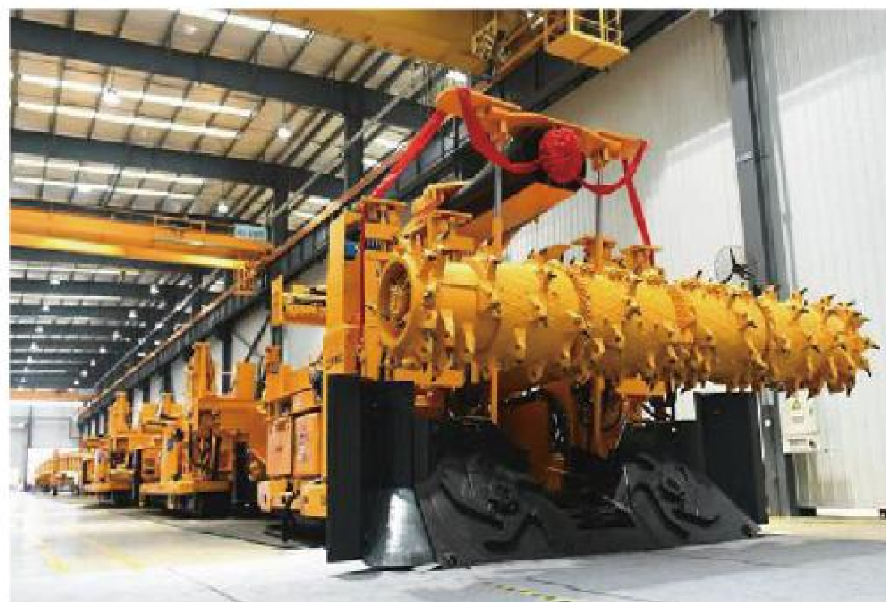
铁建重工EJM270护掘锚一体机
