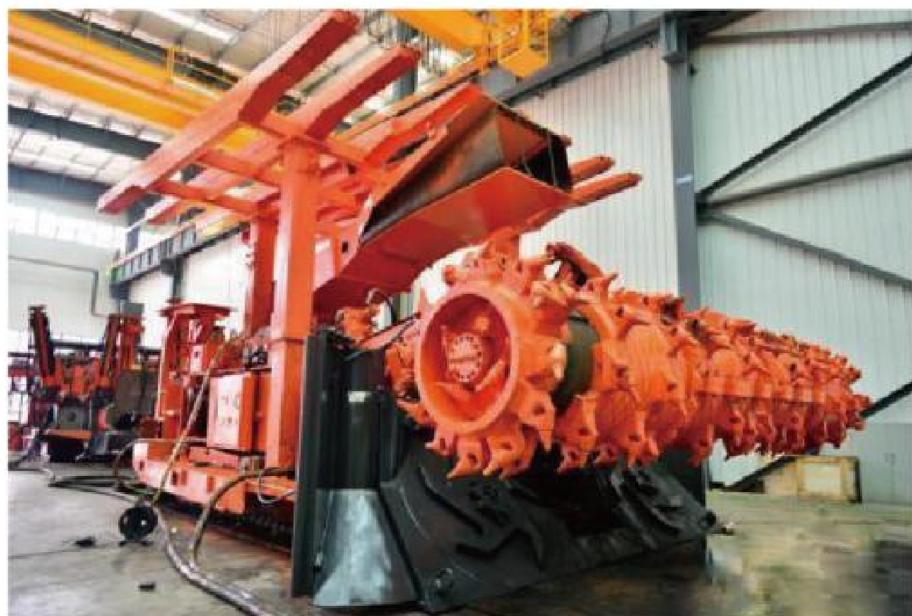
国产首台铁建重工ZJM4200护盾式掘锚一体机
