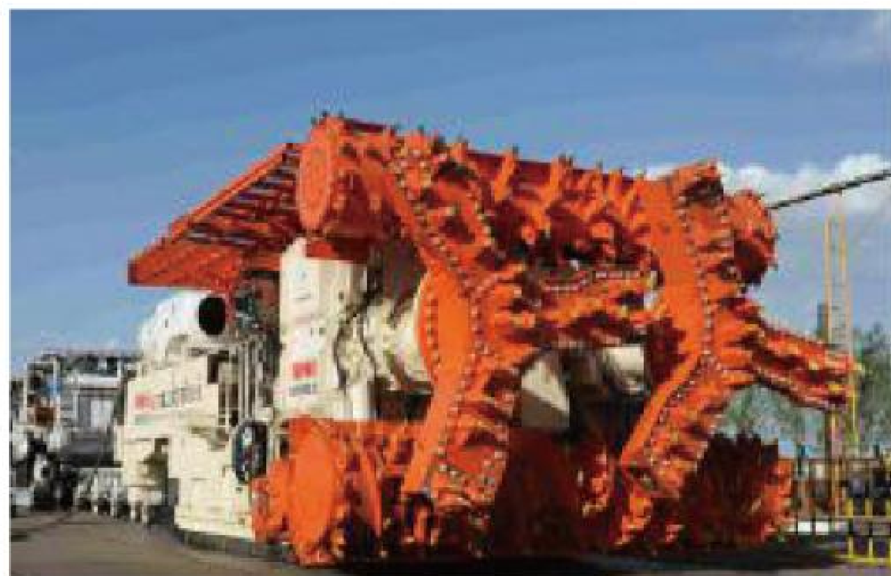
国内首套钾盐矿掘采机北方重工QMJ4260
