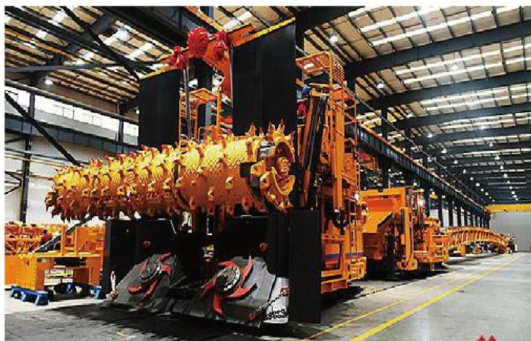
铁建重工EJM340护掘锚一体机
